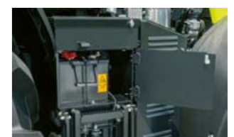
På høyre innstigning er batteriet montert lett tilgjengelig.
