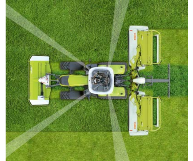
Det spesielle arrangementet av de bakre førerhusstolpene og den buede bakruten gir en fantastisk sikt for traktorføreren over både redskap og koblingsområde.
