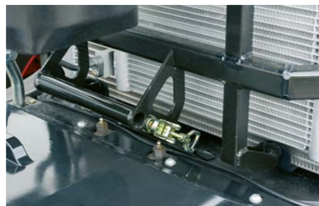
Smørepunkter på forakselen foran kjølerpakken gir optimal tilgjengelighet.
